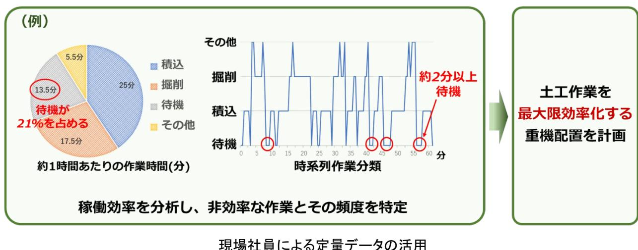
また、本モデルによる作業分類と実際の作業内容を突合し、本モデルの分類精度を検証した結果、現場の生産性向上を目指すうえで改善の余地が大きい「待機」は、97.1%と高い精度で分類できていることを確認しました。「敷均し」「転圧」「掘削」においても、それぞれ約80%の高精度で作業分類できました。
