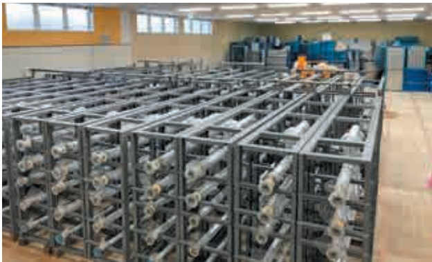
加工済み配管ユニット
