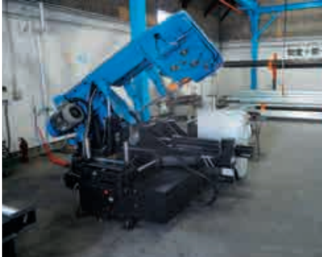
全自動バンドソー（配管切断機）
