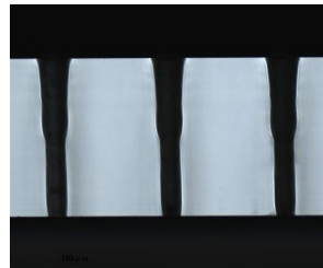
CO 2 レーザーによる ガラス基板写真（上）とその断面写真（下） （基板厚み 0.5mm、穴径Φ90μm）
